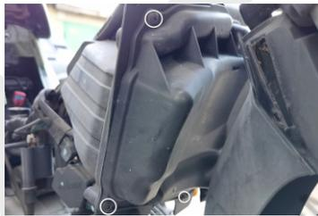
② ДЕМОНТИРУЙТЕ КРЫШКУ ВОЗДУШНОГО ФИЛЬТРА ОТКРУТИВ 5 ВИНТОВ ПОД ОТВЕРТКУ Ph2.
