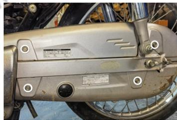
① УСТАНОВИТЕ МОПЕД НА ЦЕНТРАЛЬНУЮ ПОДНОЖКУ. ДЕМОНТИРУЙТЕ ЗАЩИТНЫЙ КОЖУХ ЦЕПИ ОТКРУТИВ 4 БОЛТА ГОЛОВКОЙ НА 10 ММ.
