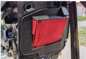
③ ПРОТРИТЕ ВНУТРИ КОРПУС ФИЛЬТРА БОКСА, ЗАМЕНИТЕ ФИЛЬТРУЮЩИЙ ЭЛЕМЕНТ, ПРОИЗВЕДИТЕ СБОРКУ В ОБРАТНОЙ ПОСЛЕДОВАТЕЛЬНОСТИ.
