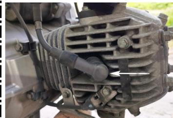
② СНИМИТЕ СВЕЧНОЙ ПРОВОД, ВЫКРУТИТЕ СТАРУЮ СВЕЧУ СВЕЧНЫМ КЛЮЧОМ НА 16ММ, ЗАКРУТИТЕ НОВУЮ СВЕЧУ С УСИЛИЕМ 15-20 НМ.
