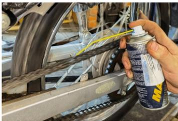
③ ПРОКРУЧИВАЯ ЗАДНЕЕ КОЛЕСО РАВНОМЕРНО РАСПЫЛЯЙТЕ СМАЗКУ В ТЕЧЕНИЕ 20 СЕКУНД. ПРОИЗВЕДИТЕ СБОРКУ В ОБРАТНОМ ПОРЯДКЕ.
