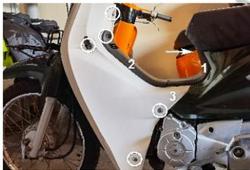
① ДЕМОНТИРУЙТЕ ПЛАСТИК В ПОСЛЕДОВАТЕЛЬНОСТИ СОГЛАСНО ЦИФРАМ, ОТКРУТИВ СУММАРНО 12 ВИНТОВ ПОД КРЕСТОВУЮ ОТВЕРТКУ Ph2.
